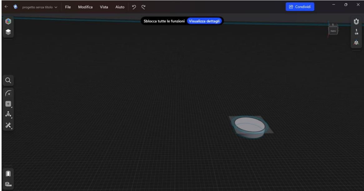
**1)** Utilizzo del comando piano di costruzione: dopo aver creato ed estruso un cilindro, ho aggiunto un piano di costruzione offset dove ho schizzato un cerchio.
